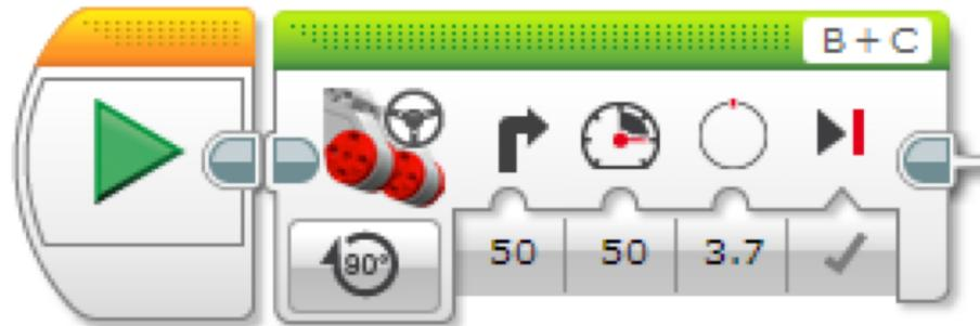
3,7 è il numero di gradi del motore che occorrono per far ruotare il DroidBot di 1° di goniometro. Dovete personalizzare questo valore basandovi sulle caratteristiche del vostro robot usando lo step 1A precedente
